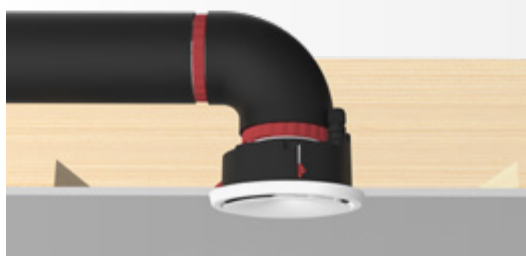
Bild 9: Einbau und Leitungsführung in Balkendecke mit modularem, gedämmtem air-lab-Schlauchleitungssystem DN 72,5 mm und System-Bogen 90°. (Quelle: air-lab GmbH)
